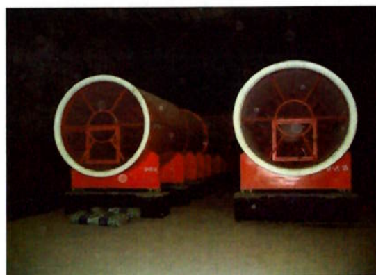
Figura 19 e 20 - Ventiladores principais em subsolo do tipo axial
